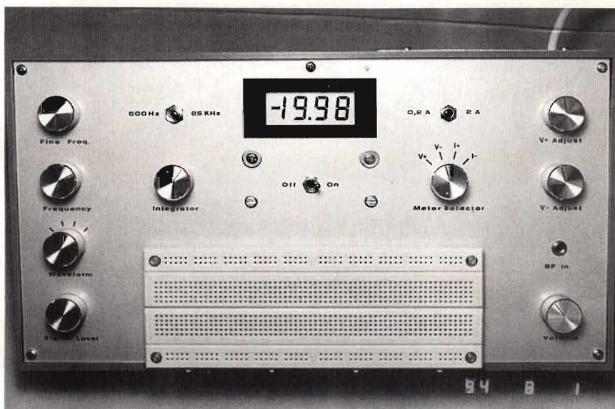
Figura 1. Vista superiore del complesso completamente montato, con la breadboard al centro, i vari comandi e il volt-amperometro.
